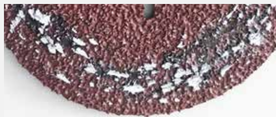
Encrassement d'un disque fibre par des copeaux d'aluminium
